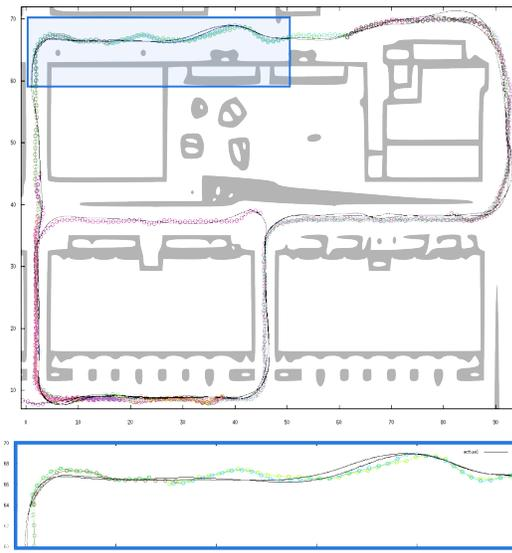
Figura 9: Trayectoria de referencia (círculos) y camino realmente ejecutado. Se incluye una vista de detalle. Las desviaciones se deben sobre todo al comportamiento de evitación. La misión involucró la ejecución de 25 trayectorias distintas.
